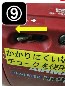
エンジンの回転が落ち着いたらチョークレバーをOFFの位置へ徐々に戻す
