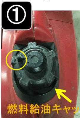
燃料給油キャップがOFFになっています
