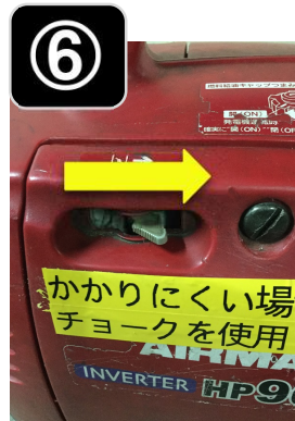
矢印の方向へスライドさせてチョークをONにする
