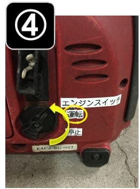
エンジンスイッチを矢印の運転へ回す
