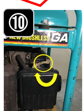
エンジンの回転が落ち着いたらチョークレバーをOFFの位置へ徐々に戻す
