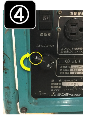
ストップスイッチを矢印のONへ回す
