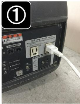
① 接続電機機器のスイッチが切られている事を確認し、コンセントからプラグを抜く
