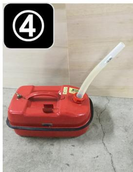
④ 専用ノズルを付ける
