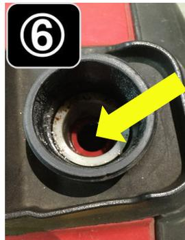
燃料キャップを外し、中を覗き込んでみると、左のような【赤い印】が見えます！この赤い箇所が【燃料満タンライン！】
