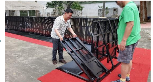
1名でパネルを起こし土台枠の ボルト穴に合わせ立てる
